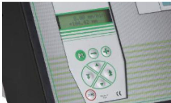
O comando manual do motor permite que um deslocamento suave da cruzeta entre em posição antes de iniciar as medições ou para ajustar os primeiros testes.
